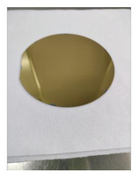
磁控溅射靶材镀膜过程中,影响靶材镀膜沉积速率的因素:溅射电压:溅射电压对成膜速率的影响有这样一个规律:电压越高,溅射速率越快,而且这种影响在溅射沉积所需的能量范围内是缓和的、渐进的。在影响溅射系数的因素中,在溅射靶材和溅射气体之后,放电电压确实很重要。一般来说,在正常的磁控溅射过程中,放电电压越高,溅射系数越大,这意味着入射离子具有更高的能量。因此,固体靶材的原子更容易被溅射出并沉积在基板上形成薄膜。
